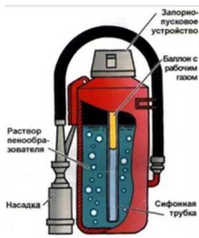
Рисунок 9 - Огнетушитель воздушно-пенный ОВП-10. (1-корпус, 2-пенный насадок, 3- трубка, 4- крышка, 5-рукоятка, 6-пусковой рычаг, 7-шток, 8-баллон со сжатым газом, 9-сифонная трубка)
