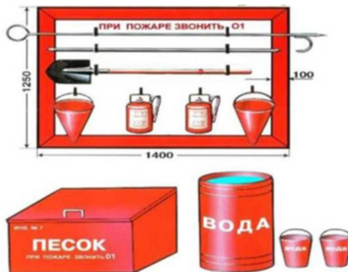
Рисунок 6 - Пожарный щит первичных средств пожаротушения
